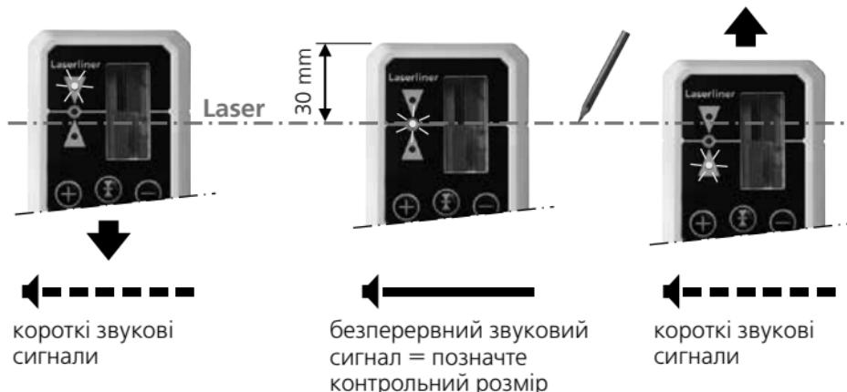
Приймач лазерного вимірювання має 2 діапазони похибки:
