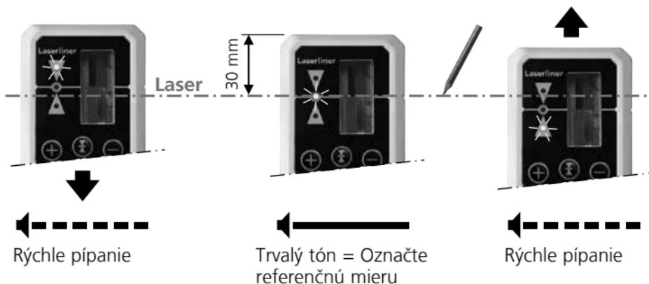
Laserový prijímač má 2 rozsahy tolerancie:
