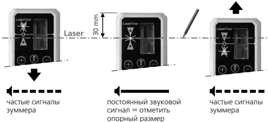
Лазерные приемники имеют 2 диапазона допусков:
