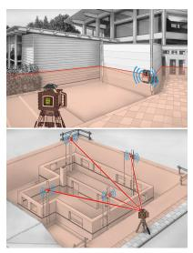
Este receptor láser es apto para láseres de rotación rojos y permite ahorrar tiempo en las tareas de alineación y nivelación a distancias cortas y largas con un alcance 200 metros. A través de una pantalla LC de fácil lectura en la parte delantera y de señales acústicas claramente perceptibles se informa al usuario de la altura del rayo láser. Incluye un soporte universal para facilitar la fijación del aparato a las miras. El imán frontal integrado sirve para fijarlo a superficies de metal.
