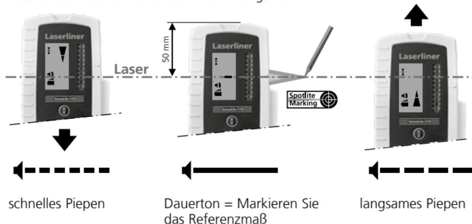
Der Laser-Empfänger verfügen über 2 Toleranzbereiche:
