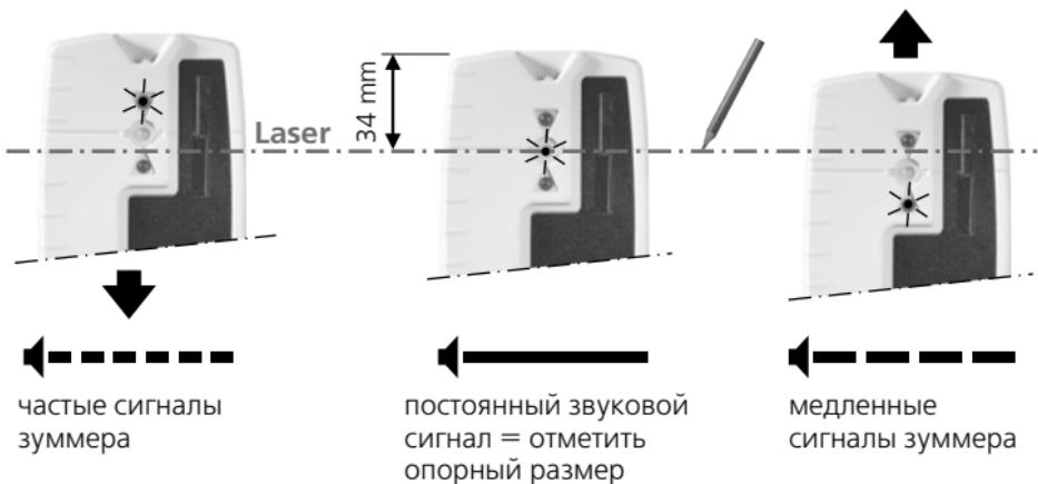
Лазерные приемники имеют 2 диапазона допусков:
