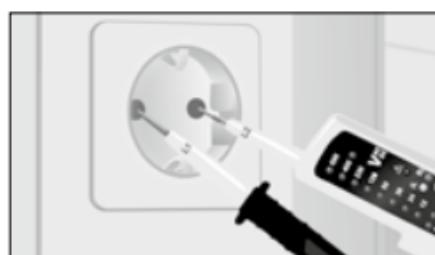
Vezměte základní přístroj (+) do pravé ruky a druhý zkoušební hrot (-) do levé ruky. Přiložte měřicí hroty ke zkoušeným kontaktům (např. kabelu, zásuvce, atd.).
