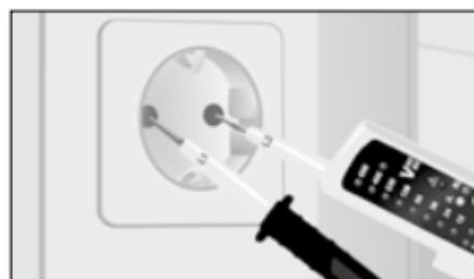
Pegue no aparelho de base (+) com a mão direita e a segunda ponta de verificação (-) na mão esquerda. Leve as pontas de medição aos contactos a verificar (p. ex. cabo, tomada, etc.).
