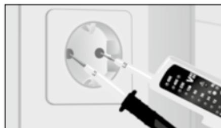
Ota laite (+) oikeaa käteen ja toinen mittauskärki (-) vasempaan käteen. Kosketa mittauskärjillä testattavaa kohdetta (esim. kaapeli, pistorasia jne.).
