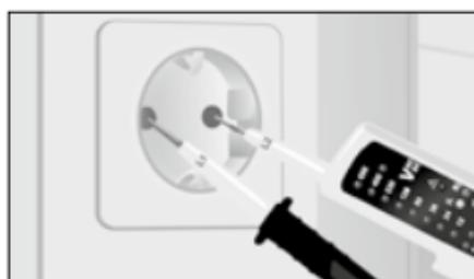
Ta basisapparatet (+) i den høyre hånd og den andre testspissen (-) i venstre hånd. Før nå målespissene til kontaktene som skal testes (f.eks. ledning, stikkontakt, etc.).
