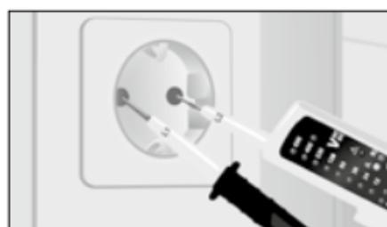
Взять в правую руку основной прибор (+), а в левую - второй измерительный наконечник (-). Подвести измерительные наконечники к тестируемым контактам (например, кабель, розетка и т.д.).
