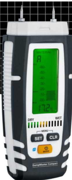
DampMaster Compact Plus es ideal para una rápida determinación de la humedad. El aparato de medición suministra el grado de humedad y sequedad del material. Ofrece una elevada precisión gracias a la medición específica para cada material. En la pantalla gráfica se muestran simultáneamente todos los datos relevantes. Los datos de las mediciones pueden ser transferidos fácilmente vía Digital Connection.
