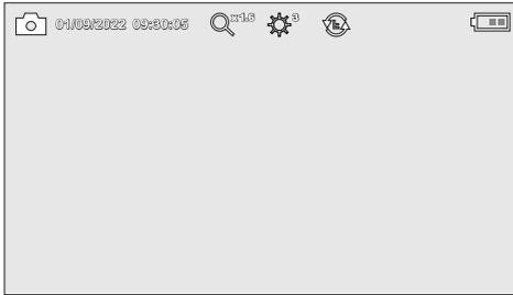
Justera in kamerahuvudet på flexslangen och placera det i den önskade positionen. Slå på lysdiodsbelysningen, om ljusförhållandena är dåliga. Zooma in avlägsna eller små objekt. Genom den manuella bildrotationen kan bilden påmonitorn vridas 180°. Tryck kort på OK-knappen för att ta bilden eller spela in videon och spara den på SD-kortet. Ett tryck till avslutar inspelningen.
