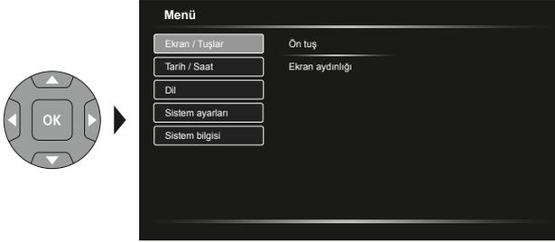
Ön tuş için aşağıdaki fonksiyonlar ayarlanabilir: Resim / Video, resim rotasyonu, aydınlatma ve yakınlaştırma. Ön ayar olarak Resim / Video ayarlanmıştır. Ekran aydınlığı üç kademe ayarlanabilir.
