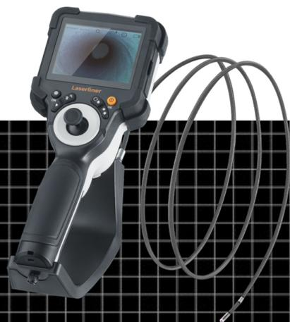
Sistema profesional de inspección por vídeo con cabezal de cámara compacto y desplazable individualmente: máxima flexibilidad para trabajos complejos e ideal para aberturas pequeñas
