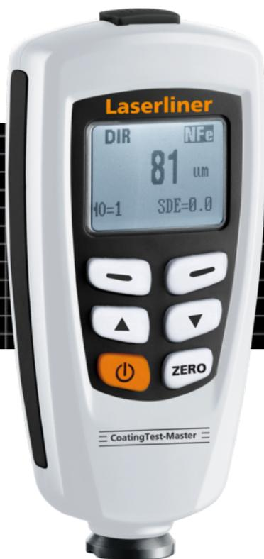
**Aparelho de medição de espessura de revestimentos para detetar espessuras não metálicas em suportes metálicos**
