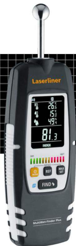
Medidor de humedad electrónico para localizar y cuantificar el alcance y los daños por humedad en paredes, suelos o techos
