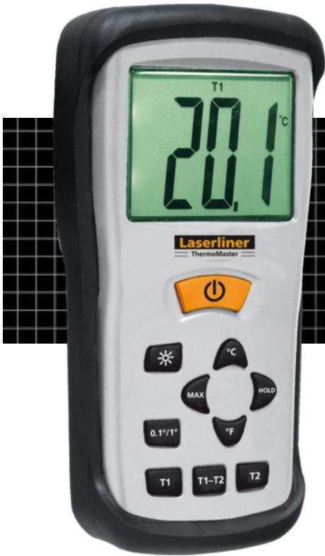
**Digitales Thermometer mit Kontaktthermoelement für den Einsatz im Labor und in der Industrie**
