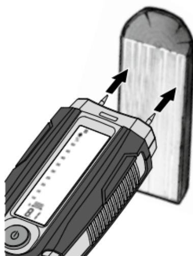
Место замера должно быть необработанным; на нем не должно быть сучков, загрязнений или смолы. Замеры не следует проводить на торцах, т.к. здесь древесина высыхает особенно быстро, а это может привести к искажению результатов измерений. **Выполните несколько сравнительных замеров поперек текстуры древесины.**
