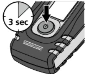
Po zapnutí přístroje se na displeji zobrazí po dobu 3 vteřin okolní teplota.
