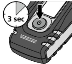
Після вмикання приладу на дисплеї на 3 секунди виводиться температура навколишнього середовища.
