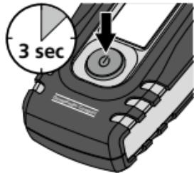
Efter att du har slagit på mätnstrumentet, visas omgivnings-temperaturen på displayen i 3 sekunder.
