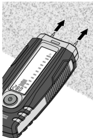
Değişik materyellerden碌enerek olu碌an duvarlarda (alanlarda) veya yapı malzemelerinin değişik bileşimlerden oluşu durumda hatalı ölçüm değerlerinin oluşabileceгine dikkat edilmesi gerekmektedir. **Kıyaslama amacı ile birden fazla ölçüm yapınız.**
