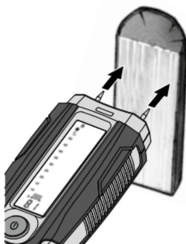
Stedet som skal måles skal være ubehandlet og fritt for grener, smuss eller harpiks. Det skal ikke utføres en måling på frontsider, for treet tørker spesielt fort der og dette kunne gi gale måleresultater.
