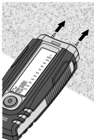
Je třeba mít na paměti, že u stěn (ploch) s různým uspořádáním materiálu nebo u různého složení stavební hmoty může docházet k nepřesnému výsledku měření.
