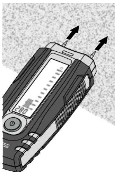
É preciso ter em conta que paredes (superfícies) com uma ordenação de materiais diferente, mas também a composição diferente dos materiais de construção, podem falsificar os resultados de medição. **Efetue várias medições comparativas.**
