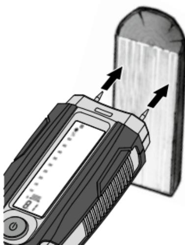
Mittauskohdan tulisi olla käsittelemätöntä puuta eikä siinä saa olla oksankohtaa, likaa eikä pihkaa. Älä mittaa laudan päästä äläkä etupuolelta, koska puu kuivuu tällaisissa paikoissa nopeammin; mittaustulos saattaa olla virheellinen. **Tee useita vertailevia mittauksia puun syiden poikkisuunnassa.**
