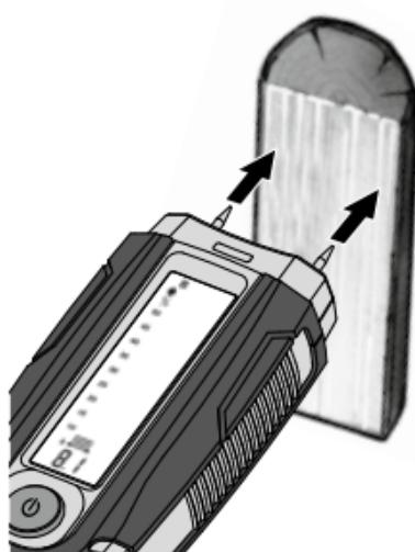
Místo měření by nemělo být nijak ošetřeno, nesmí na něm být větve, nečistota nebo smola. Na čelních stranách by neměla být prováděna žádná měření, protože dřevo zde obzvlášť rychle vysychá, což by vedlo ke zkresleným výsledkům měření. **Provedte několik srovnávacích měření kolmo na kresbu dřeva.**
