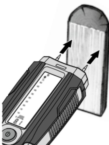
Місце для вимірювання повинне бути неопрацьованим і вільним від гілок, бруду або смоли. Не виконувати вимірювання на торцевих сторонах, тому що деревина тут особливо швидко висихає та таким чином сприяє отриманню помилкових результатів вимірювання. **Виконайте декілька порівняльних вимірювань упоперек волокон.**
