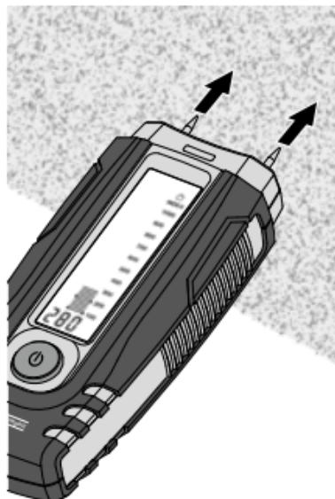
Слід пам'ятати про те, що на стінах (поверхнях) з різним розташуванням матеріалів бо також з різним складом будматеріалів результати вимірювання можуть бути невірними.
