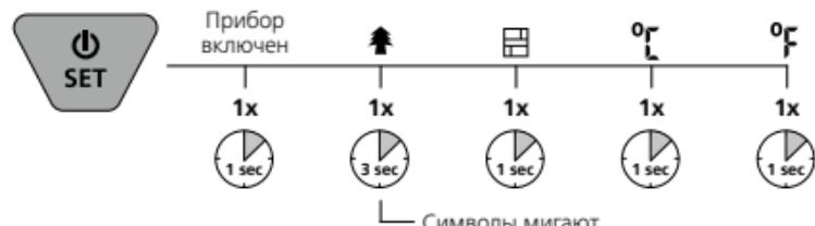
**!** Прибор запускается из режима, который был выбран в последний раз. Для выбора режима удерживать нажатой кнопку Set в течение 3 секунд или немного подождать, пока символ не перестанет мигать.
