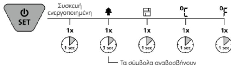
**!** Η συσκευή ξεκινά με ενεργοποιημένη τη λειτουργία μέτρησης που είχε επιλεγεί τελευταία. Για επιλογή της λειτουργίας, πατήστε το πλήκτρο Set για 3 δευτερόλεπτα ή περιμένετε λίγο, έως ότου το σύμβολο πάψει να αναβοσβήνει.
