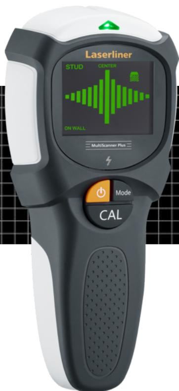
Aparelho eletrônico de localização de objetos de metal, linhas elétricas, bem como vigas e travessas - incluindo indicação de profundidade no modo de metal e indicação de centro e rebordos na localização de vigas e travessas
