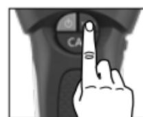
**AC-SCAN:** Локализиране на проводници под напрежение до 2 см непосредствено под неметални обшивки.
