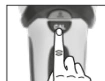
Kalibrasyon esnasında cihazı havaya kaldırıp tutarsanız maksimum cihaz hassasiyetini elde edebilirsiniz. Bu yöntem METAL ve AC-SCAN ölçümlerinde yer yer mantıklı olabilir.
