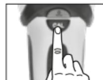
Hold apparatet i luften under kalibreringen for å oppnå maks. apparatfølsomhet. Dette kan være en fordel ved METAL- og AC-SCAN-målinger.
