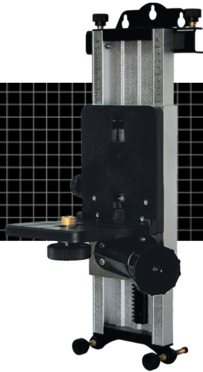
Cette fixation murale est compatible avec tous les lasers rotatifs et à lignes disposant d'un filetage de 5/8 po. La molette de réglage permet un réglage en hauteur précis. La pince permet une suspension à des éléments de construction.
