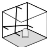
Ne otpuštati transportni zatvarač, klizni prekidač (2) gurnuti u lijevo. Odabrat i uključiti laser tipkom za odabir. Sada se mogu mjeriti kose ravnine. Ovaj način rada se ne može koristiti za obavljanje horizontalnog ili vertikalnog niveliiranja jer se laserske linije više ne poravnavaju automatski. Laserske linije trepću zeleno.
