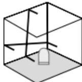
Prepravnú poistku neuvoľnite, posuvný vypínač (2) posuňte dočava. Laser zapnite tlačidlom ZAP/VYP. Teraz môžu byť vytvorené šikmé roviny. V tomto režime nie je možná horizontálna, resp. vertikálna nivelácia, pretože laserové línie sa už automaticky nenasmerujú. Laserové čiary blikajú na zeleno.
