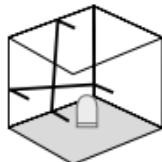
Не освобождавайте транспортната блокировка, преместете плъзгача (2) наляво. Изключете лазера с бутона ВКЛ./ИЗКЛ. Сега може да се зададат наклонени равнини. В този режим не може да се нивелира хоризонтално, съответно вертикално, тъй като лазерните линии вече не се насочват автоматично. Лазерните линии мигат в зелен цвят.
