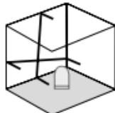
Nu slăbiți șuruburile pentru transport, poziționați comutatorul glisant (2) spre stânga. Laserul se operează prin tasta PORNIRE/OPRIRE. Acum se pot marca suprafețele inclinate. În acest mod nu se poate nivela în plan orizontal resp. vertical, pentru că razele laser liniare nu se mai ajustează automat. Liniile laser luminează verde intermitent.
