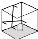
Transportnega varovala ne odpeti, drsno stikalo (2) potisnite v levo. Laser vključite s tipko za VKLOP/IZKLOP. Sedaj lahko naložite poševne ravni. V tem načinu ni mogoče nivelirati vodoravno oz. navpična, ker se laserske linije več ne poravnajo samodejno. Laserske linije utripajo zeleno.
