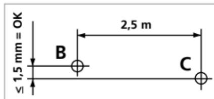
prestavite pribl. 2,5 m v desno in označite točko C. Preverite, ali je vodoravna linija točke C  $\pm 1,5 \text{ mm}$  na enaki višini s točko B. Postopek ponovite še s premikom v levo.
