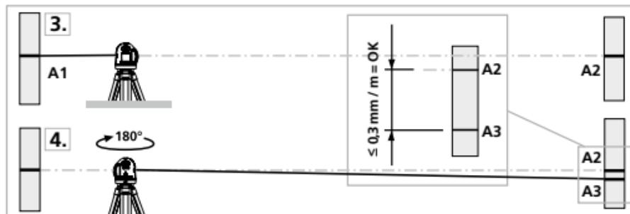
! Om A2 och A3 ligger mer än  $0,3 \text{ mm} / \text{m}$  från varandra behöver enheten justeras. Kontakta er återförsäljare eller vänd er till serviceavdelningen på UMAREX-LASERLINER.
