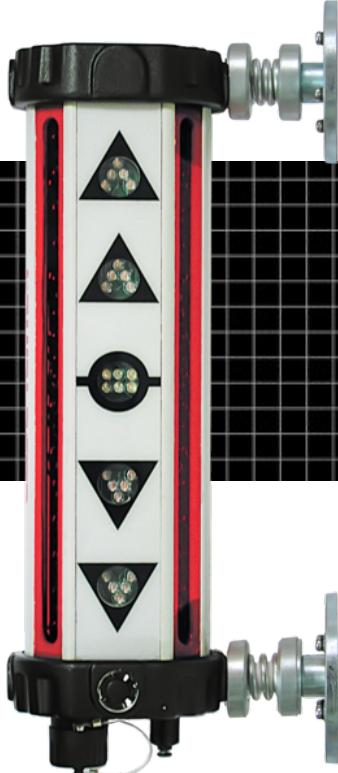
En combinación con un láser rojo giratorio, el SensoPilot Pro se utiliza para la regulación permanente de la altura en el control de maquinaria de construcción. Cuatro unidades receptoras permiten recibir el láser en un radio de 360° y un alcance de 200 metros. Los LEDs grandes y muy visibles indican el nivel del láser. La unidad tiene una carcasa resistente al agua y al polvo y se puede fijar fácilmente a la máquina con los fuertes imanes de sujeción.
