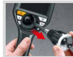
Possível substituição da unidade da câmara
