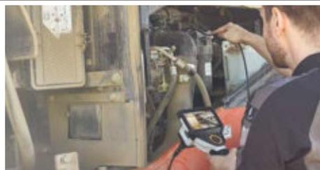
**Sistema de inspeção com vídeo profissional de alta resolução com vista frontal e lateral variável**
