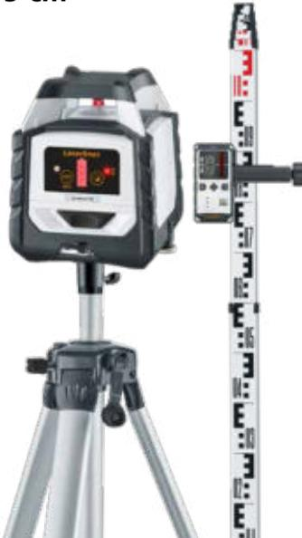
**Robuster, horizontaler 360°-Linienlaser mit Anti-Drift-System, Laserempfänger RangeXtender 60, Kompaktstativ 175 cm und Teleskop-Nivellierlatte 3 m**
