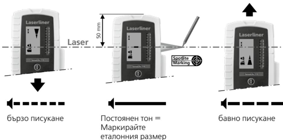
Лазерният приемник разполага с две зони на допуск:
