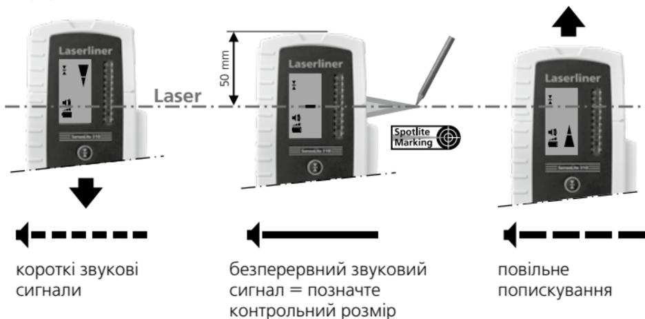
Приймач лазерного випромінювання має 2 діапазони похибки:
