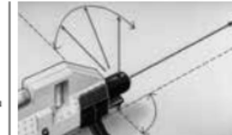
Con il divisore raggio a 90° il raggio laser può essere deviato ulteriormente di 90°.
