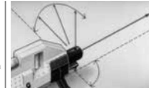
Med 90° strålfördelare kan laserstrålen dessutom vridas 90°.
