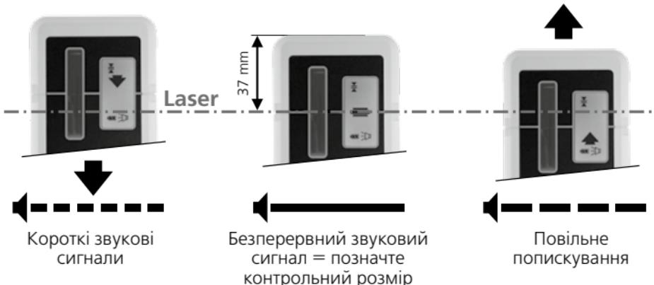
! Приймач лазерного випромінювання має 2 діапазони похибки:
