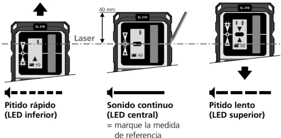
! La radiación solar directa puede reducir el alcance del recepción del láser.
