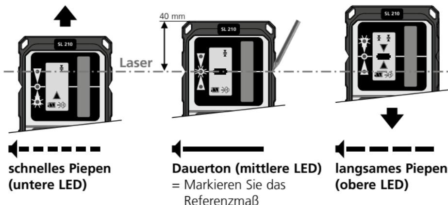
! Bei direkter Sonneneinstrahlung kann sich die Reichweite des Laserempfangs reduzieren.
