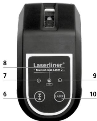
**!** Sammuta aina kuljetuksen ajaksi kaikki laserit. Lukitse heiluri ja siirrä liukukytkin asentoon OFF!
