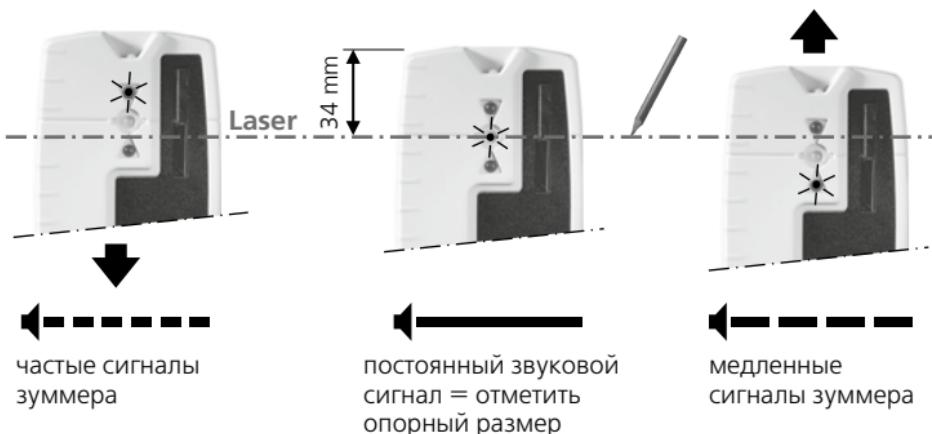
Лазерные приемники имеют 2 диапазона допусков:
