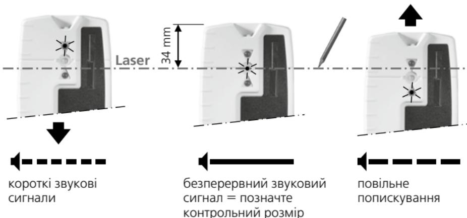
Приймач лазерного випромінювання має 2 діапазони похибки:
