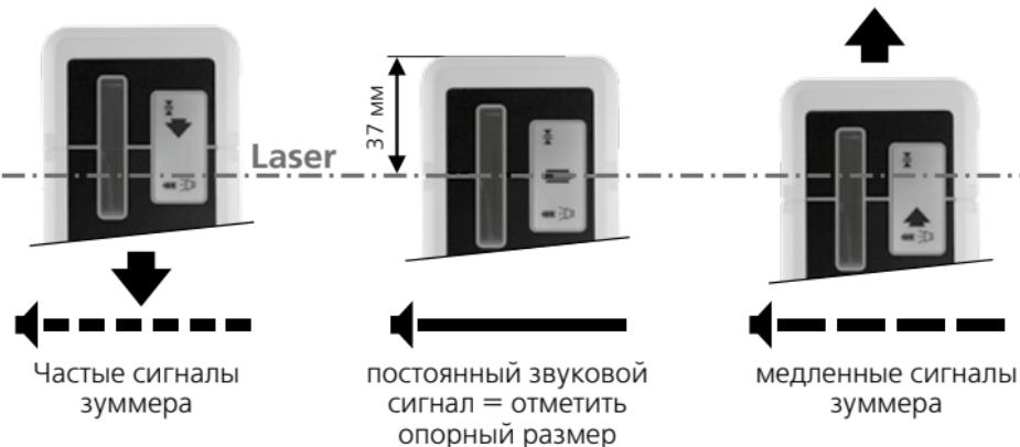
Лазерные приемники имеют 2 диапазона допусков:
