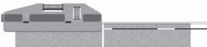
За полагане на плочки на стена уредът се поставя върху първата плочка с помощта на пружинния фиксатор, който може да се избута с щифтовете от задната страна. Лазерният лъч, който преминава успоредно на хоризонталната либелка, насочва по продължението на ръба на плочката. По този начин плочката може да се нивелира прецизно с помощта на либелата.
