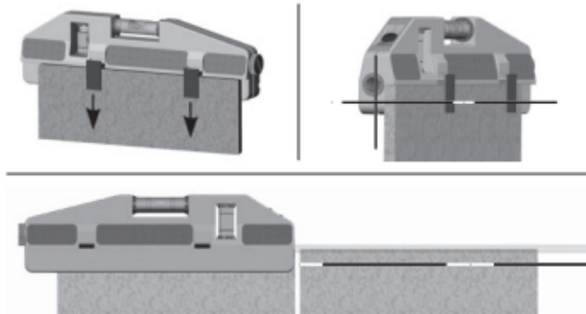
Pri pokladke obkladov sa prístroj pripievá na prvú obkladačku pomocou pružinovej svorky, ktorá sa dá vytiahnuť pomocou vzadu umiestnených kolíkov. Laserový lúč, ktorý je rovnobežný s horizontálnou vodováhou, vedie pozdĺž okraja dlaždice. Vďaka tomu je možné presné vyrovnanie vodováhy.
