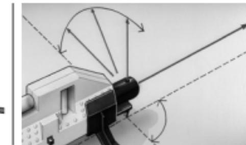
С помощью разделителя луча на 90° можно изменить направление лазерного луча на 90°.
