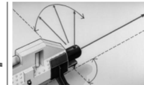
90-кутовий світлоподільник дозволяє додатково розвертати лазерний промінь на 90°.
