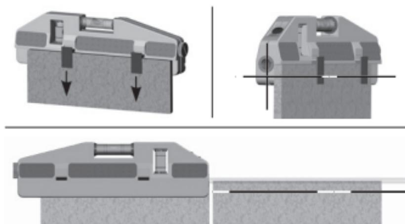
Duvar fayanslarının döşenmesi için cihaz, arka taraftaki kalemler sayesinde dışarı sürülebilen yaylı kıskaçlı sabitleme düzeneği yardımıyla ilk fayansın üzerine takılır. Yatay tesviye ruhuna paralel olarak düşen lazer ışını fayans kenarın boyunca uzanmaktadır. Böylece fayans tesviye ruhu ile kolayca hizalanabilir.
