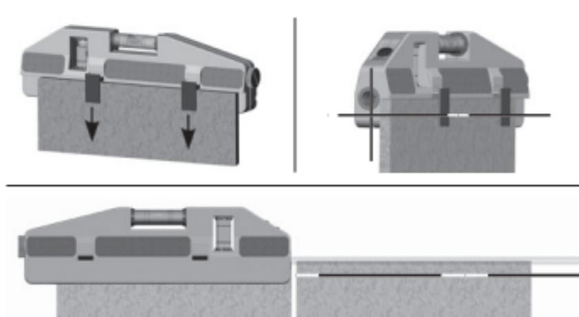
Για την τοποθέτηση των πλακιδίων τοίχου στερεώνεται η συσκευή επάνω στο πρώτο πλακίδιο με το κλιπ στήριξης το οποίο σύρεται προς τα έξω με τους πείρους στην πίσω πλευρά. Η ακτίνα λέιζερ που τρέχει παράλληλα με την οριζόντια αεροστάθμη οδηγεί κατά μήκος της ακμής των πλακιδίων. Έτσι ευθυγραμμίζεται το πλακίδιο με ακρίβεια στην αεροστάθμη.
