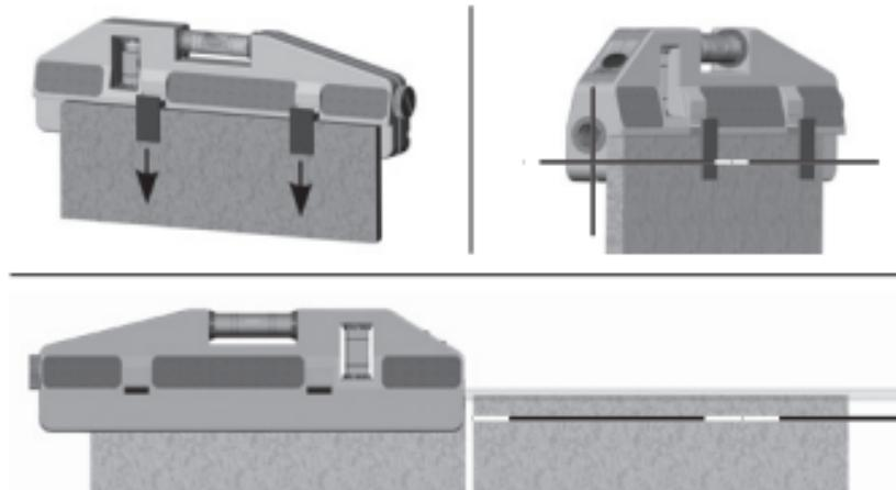
Для укладки плитки для облицовки стен прибор закрепляют на первой плитке с помощью пружинного зажимного крепления, которое выдвигается за счет расположенных с обратной стороны штифтов. Лазерный луч, проходящий параллельно горизонтальному пузырьку в уровне, ведет вдоль края плитки. Так плитку можно выровнять точно по уровню.
