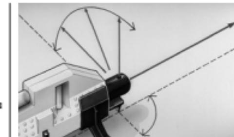
A 90°-os sugárosztóval a lézersugár 90°-ban eltéríthető.
