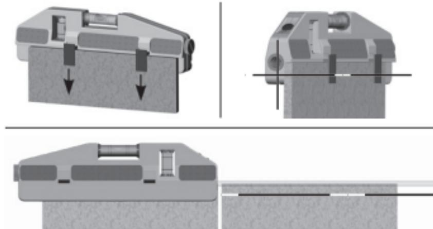
Для укладання стінової керамічної плитки слід встановити прилад за допомогою прижинового затиска, що розсувается за допомогою розташованих ззаду штифтів, на першу плитку. Сплюмувати лазерний промінь вздовж окрайку плитки паралельно поземниці. Це дозволить точно вирівнювати плитки поземницею.
