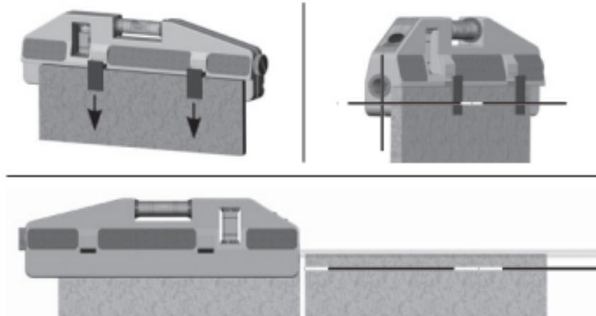
Pentru montarea faianței aparatul se introduce în prima placă de faianță cu ajutorul suportului de prindere cu arcuri prin șifturile de pe partea posterioară cu ajutorul căruia se poate împinge afară. Raza laser aflată paralel cu nivela orizontală trece de-a lungul cantului plăcii de faianță. Astfel placă de faianță se poate alinia exact cu ajutorul nivelei.
